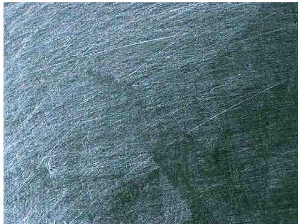
Bild X: Feuerverzinkung nach Reinigung
